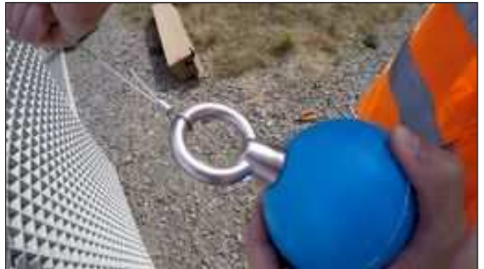
9. Passer le câble dans boulon à œil
